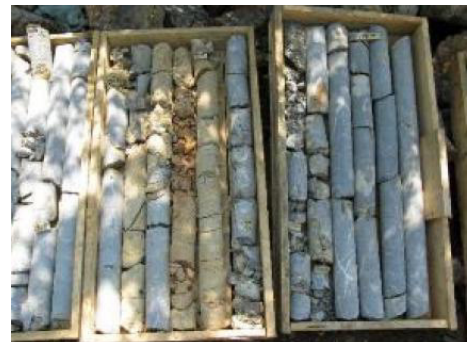
Слика број 8 - Глиновита испуна каверне, В6/19
